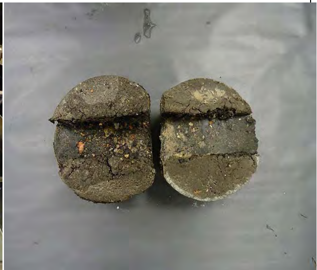
(d) Failed specimen (rut depth > 20mm)
