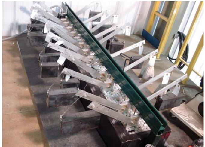
**FIGURE 3 - LONG-TERM TESTING FRAMES IN TEMPERATURE-CONTROLLED CONTAINERS**
