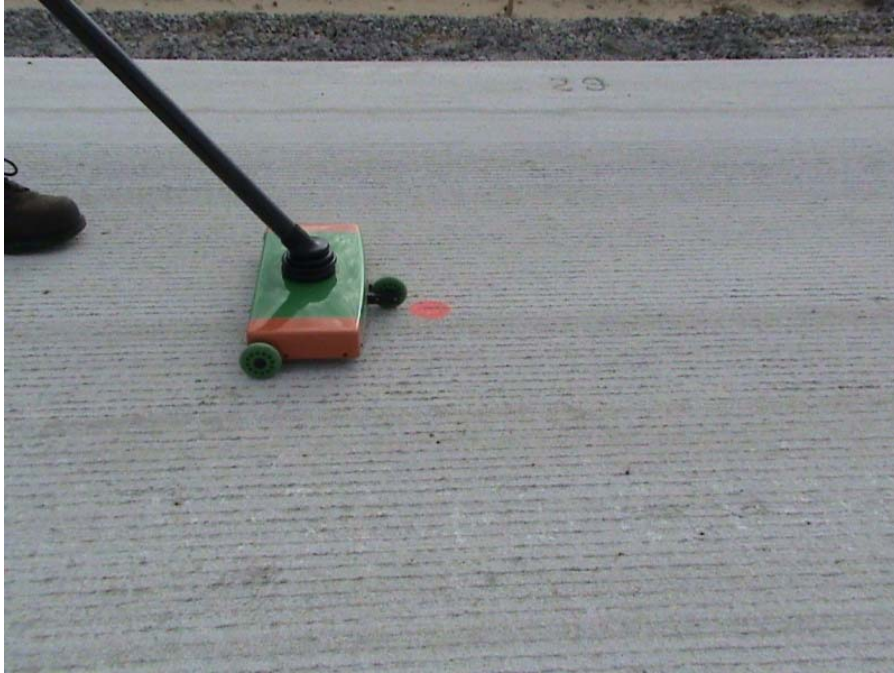
Figure 2 MIT T2 running over test location.
