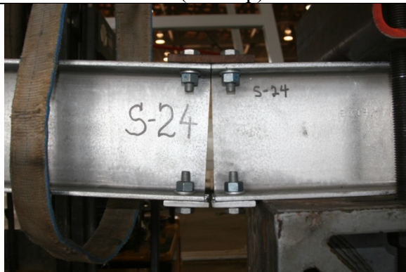
(d) Fuse Plate Connection after Failure (No Gap)
