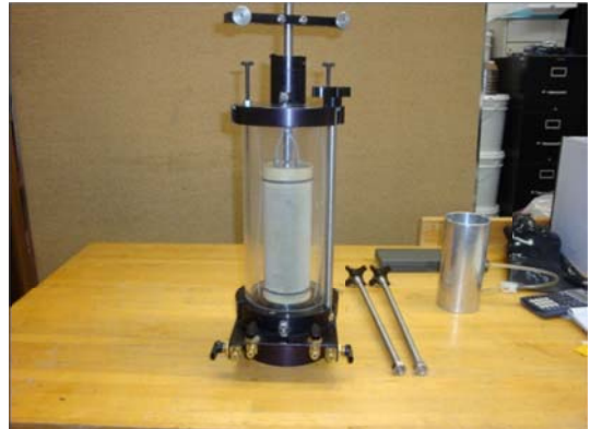
(d) Assembly of triaxial cell
