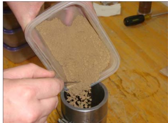
(d) Filling the mold
