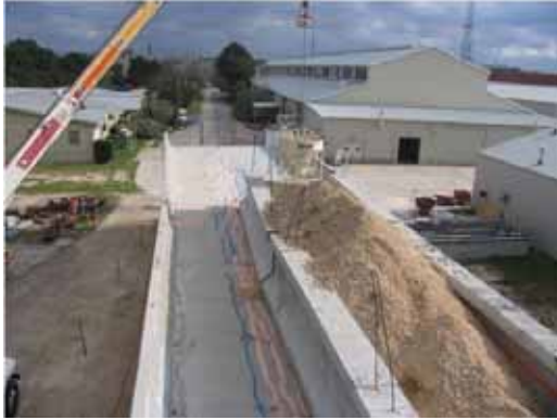
(d) Deck hinge formation along IG-In top flange
