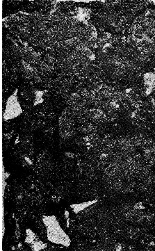
Freeze-thaw (Kling Beta LV) TSR = 0.90
