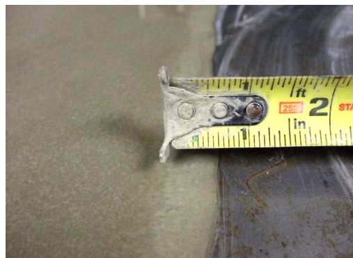
(d) Example of a 0.5 in. (12.7 mm) VGSI
