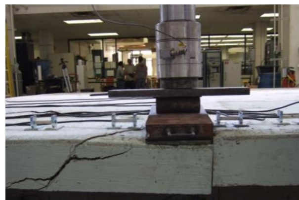
(d) Specimen 2 lab-cast overhang failure load
