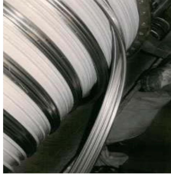
Figure 11B. Steel Reinforce Lining ( www.prsrohrganierung.de )
