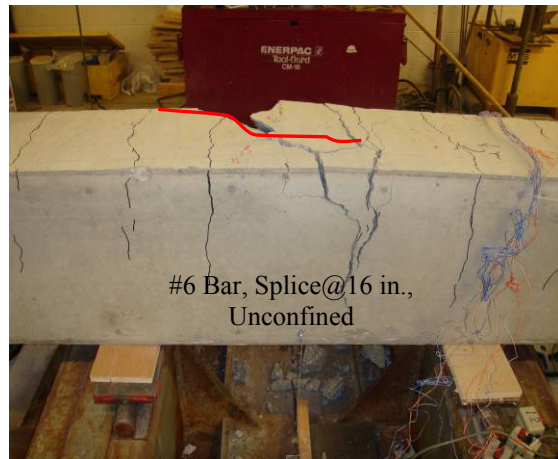
(d) Split failure of B-6-4
