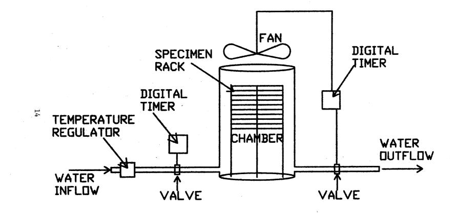
Fig. 1. Wet-Dry Test Setup
