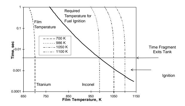
FIGURE 9. TEMPERATURE–TIME HISTORY OF FILM AROUND FRAGMENT AND TEMPERATURE–TIME REQUIRED FOR IGNITION IN ULLAGE AT SEA LEVEL ( $V_0 = 237 \text{ m/s}$ , 59 g FRAGMENT)
