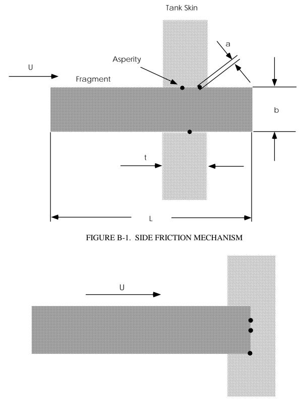
FIGURE B-2. FRONT COMPRESSION MECHANISM
