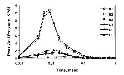
FIGURE 16. PEAK WALL PRESSURE EVOLUTION AFTER FRAGMENT IMPACTS THE FUEL TANK
