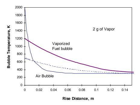
FIGURE 15. TEMPERATURE OF A BUBBLE RISING THROUGH LIQUID FUEL TO THE FREE SURFACE
