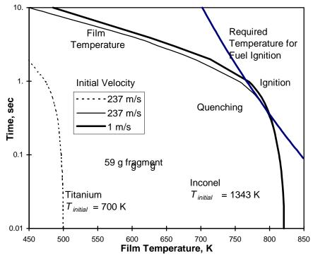
FIGURE 12. TEMPERATURE–TIME HISTORY OF VAPOR AT BOILING SURFACE AND TEMPERATURE–TIME REQUIRED FOR IGNITION IN LIQUID FUEL
