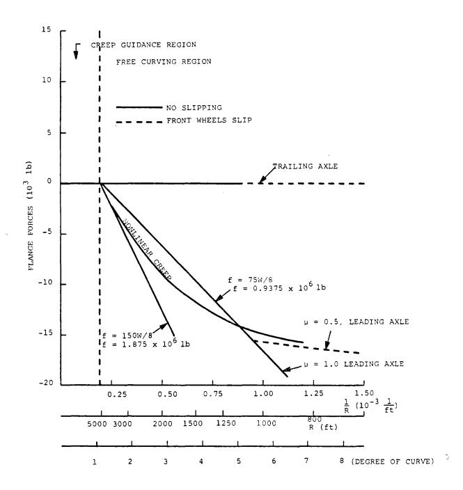
FIGURE 8. FLANGE FORCE VERSUS RADIUS. COMPARISON OF LINEAR AND NONLINEAR CREEP CALCULATION
