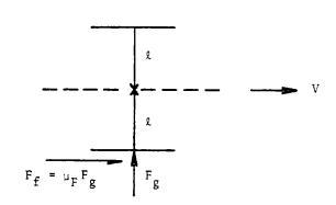
FIGURE 10. FLANGE FORCE AND FRICTION FORCE DUE TO FLANGE FRICTION
